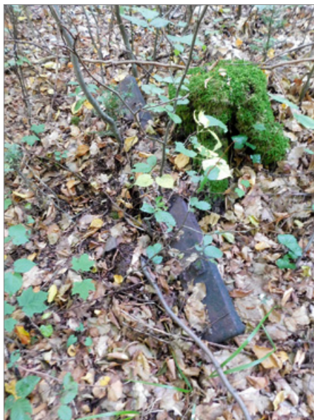
Porzucony w okolicach Osieczna podkład stalowy od rosyjskiego wojskowego przęsła torowego 750 mm systemu Dolberga- Jałowieckiego, fot. Bartosz Kozak
